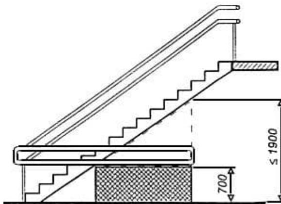
Предохранительная защита или поручни в зоне опасности
