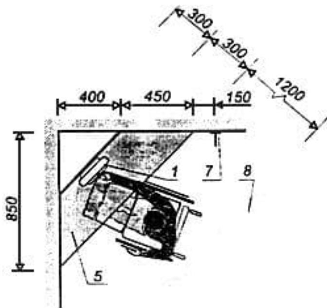
1 - телефонный аппарат; 2 - телефонная будка; 3 - зоны для подъезда кресла-коляски; 4 - список телефонов экстренного вызова и другая информация; 5 - полка или место для размещения телефонного справочника; 6 - откидное сидение; 7 - крючок для костыля или трости; 8 - рельефная полоса или смена цвета в покрытии пола
