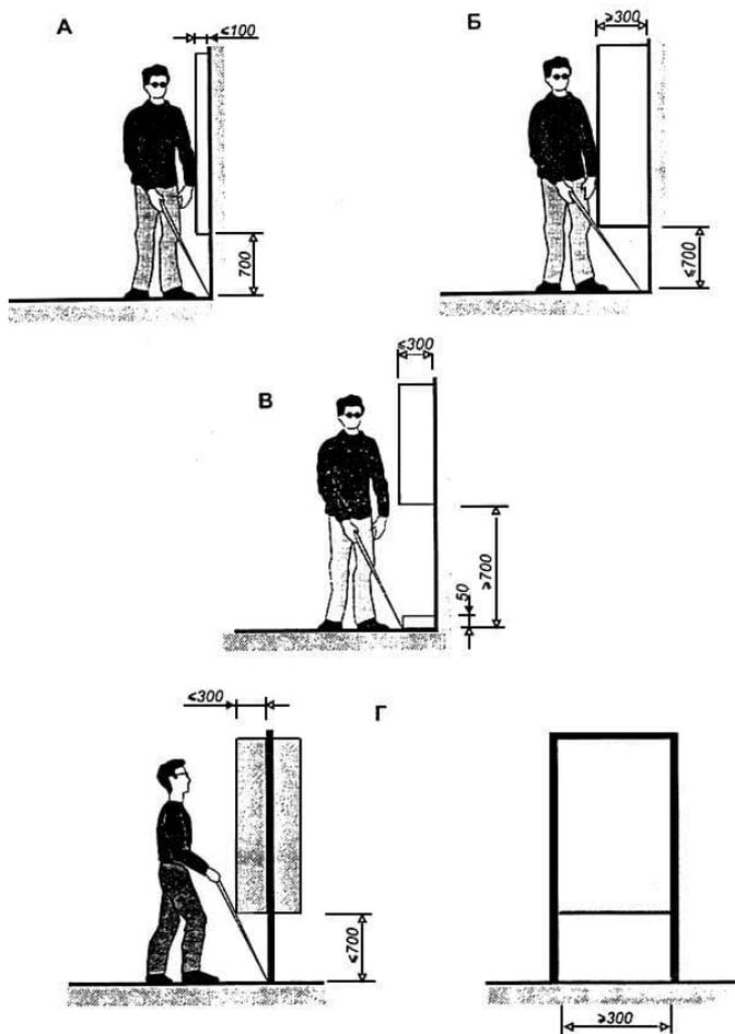
А, Б - допустимые параметры вертикальных преград, размещаемых параллельно стене;
