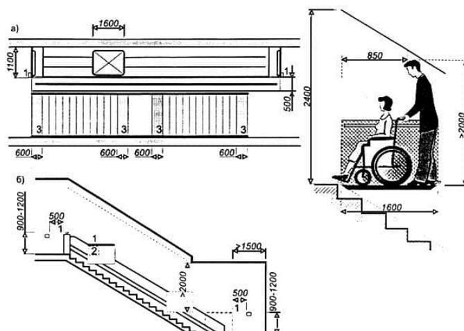
а - перемещение подъемника параллельно лестнице; б - перемещение лестничного подъемника
