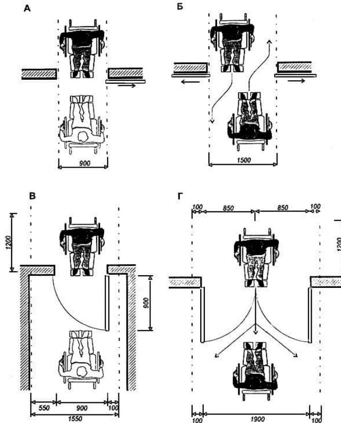
Минимальные габариты свободных площадок с обеих сторон дверного проема раздвижных однопольных (А) и двухпольных (Б) дверей, распашных однопольных (В) и двухпольных (Г) дверей.
