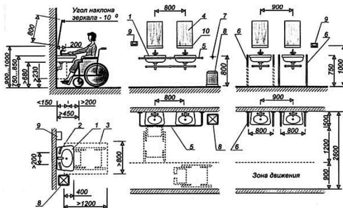
1 - раковина умывальника; 2 - рычаги управления кранами (вариант); 3 - зона кресла-коляски; 4 - зеркало (при наклоне середины зеркала - на высоте 1250 мм); 5 - горизонтальная опора; 6 - откидывающаяся опора-кронштейн; 7 - кнопка управления крышкой бачка; 8 - мусорный бачок; 9 - полотенце (фен); 10 - полка
