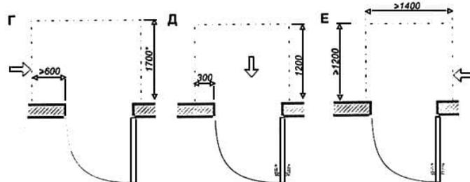
А, Б, Г - двери без запора; В - дверь с закрывателем; Д, Е - двери, имеющие ручку и закрыватель
