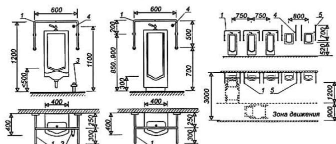
1 - поручни опоры; 2 - смывной кран (ручной); 3 - смывной кран (ножной); 4 - кнопка управления смывом; 5 - опора вертикальная
