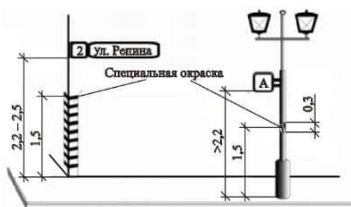
Рисунок 75 – Особенности размещения и параметры визуальных указателей в пределах пешеходного пути
