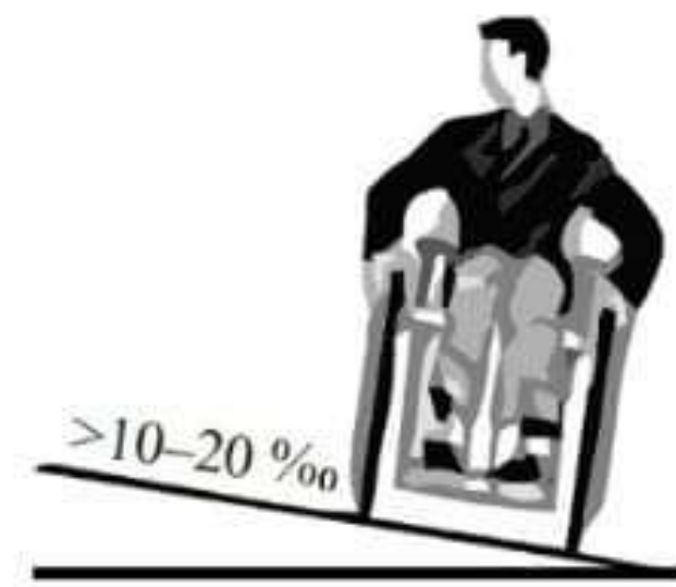
Рисунок 5 - Положение кресла-коляски с инвалидом при максимально допустимом значении поперечного уклона.
