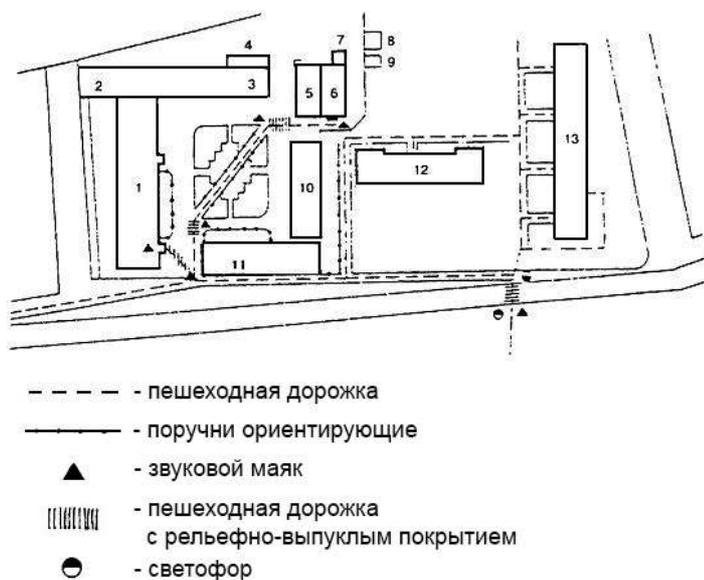
1 - производственный корпус; 2, 3 - складские помещения; 4 - компрессорная; 5 - котельная; 6 - производственный корпус; 7 - сварочное отделение; 8, 9 - трансформаторные подстанции; 10 - складские помещения; 11 - административный корпус; 12, 13 - жилые дома
