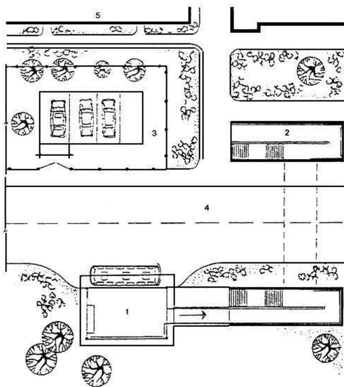
1 - светофор со звуковым маяком; 2 - островок безопасности; 3 - участки тротуара с рельефным покрытием
