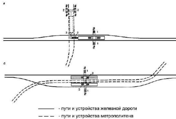
1 - лестницы, обустроенные пандусом; 2 - вход-выход с устройством подъемника; 3 - вход-выход с устройством эскалатора
