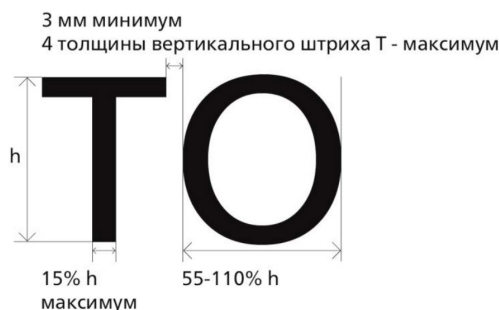
Рисунок 24 — Пропорциональные соотношения элементов шрифтовых знаков
