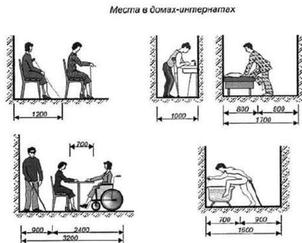
Рисунок Г.4 - Параметры функциональных зон
