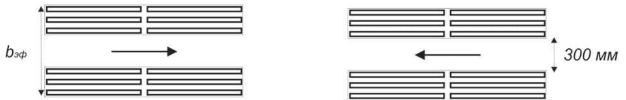
Рисунок А.6 — Форма рифления — прямолинейные параллельные рифы с плоской вершиной (6 шт.), используемые для обустройства направляющего указателя для движения в одном направлении
